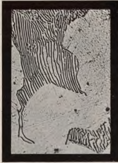
Fig. 130. Hypo-eutektischer Stahl. Lamellarer Perlit + Ferrit.
